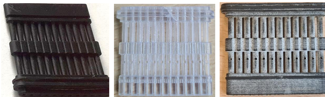
Figure II-6. Barrettes amovibles utilisées pour cette étude : Invicta (noire), Vitra (transparente) et PA12 (grise).
