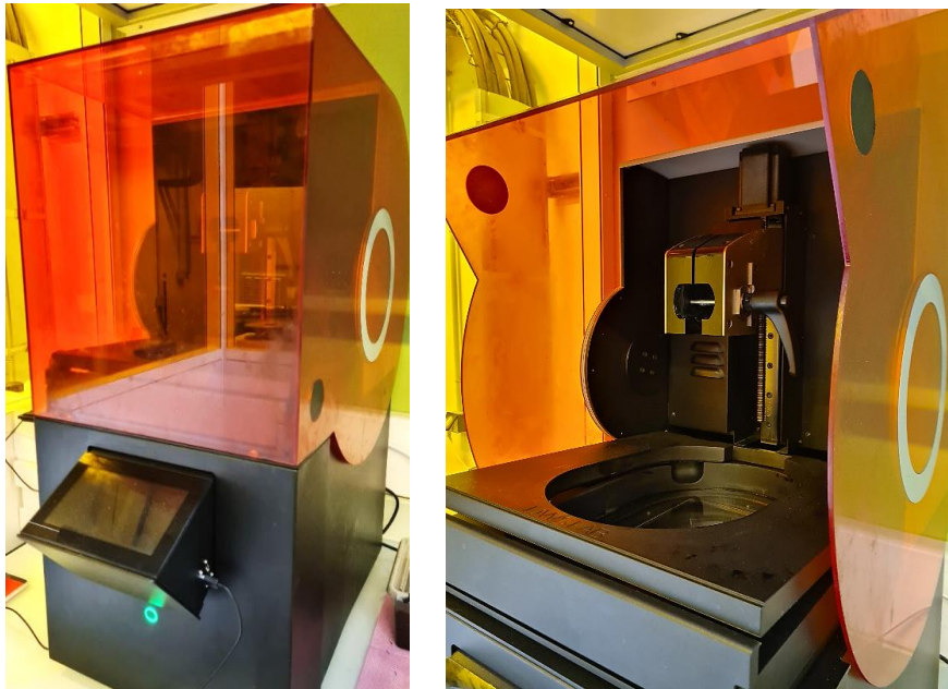
Figure II-8. Imprimante 3D (DWS XFAB 3500 PD, DWS Systems) utilisée pour la réalisation des pièces du pilote par stéréolithographie. : vue arrière et vue avant.
