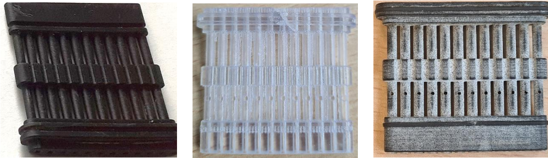
Figure IV-2. Barrettes amovibles utilisées pour cette étude, réalisées dans trois matériaux différents : Invicta (noire), Vitra (transparente) et PA12 (grise).
