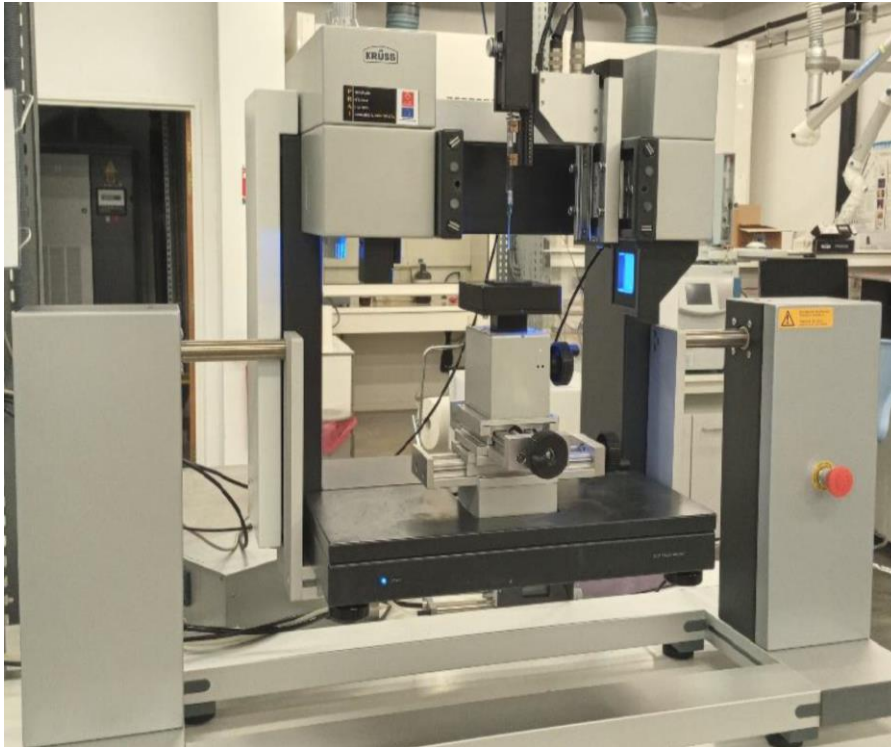
Figure IV-4. Tensiomètre (Krüss DSA100) utilisé pour les mesures d'angles de contact.
