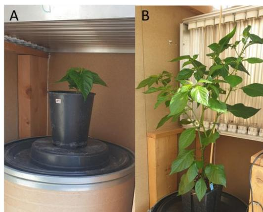
Figure 26. Enceinte d'application des traitements UV-C. A. Traitement vertical pour les plantes au stade précoce, où l'apex est éloigné de 10 cm des lampes. B. Traitement horizontal visant à cibler la zone présentant les fleurs et les fruits chez les plantes au stade avancé.
