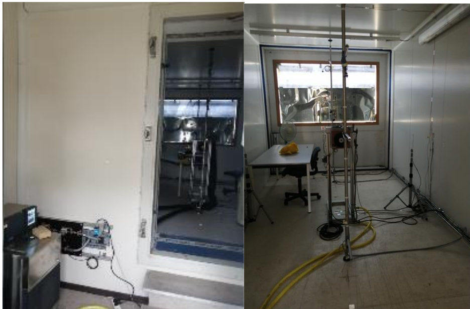
Figure 5-15 : Système de chauffage/refroidissement, à gauche: Génération – Bain thermostatique, à droite: Vue de l'intérieur de la cellule Passys
