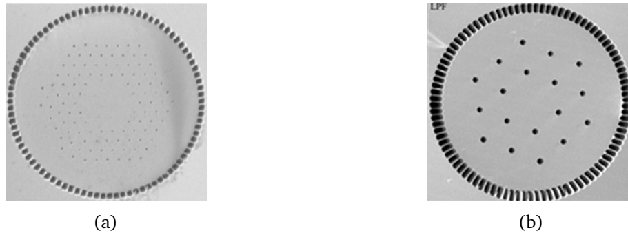
FIGURE 2.15 – Images microscope des profils PCF 80/200 \mu\text{m} (a) et LPF 62/170 \mu\text{m} (b)
