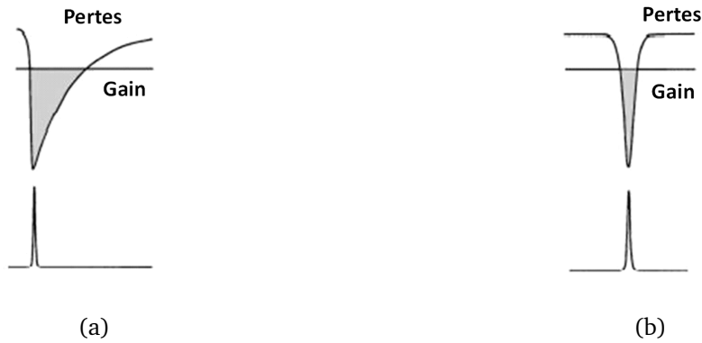
FIGURE 3.8 – Méthode de verrouillage de modes en phase passif dans le cas d'un gain saturé. (a) : Cas d'un absorbant saturable lent, le SESAM. (b) : Cas d'un absorbant saturable rapide, la lentille de Kerr. Figure extraite de [69].
