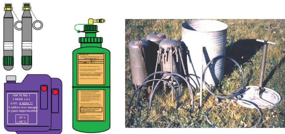
Figure 19 - Appareil de décontamination chimique de 2.5 L à recharge F1 (D'après « Les matériels et équipements de défense N.B.C – TTA 601 bis)
