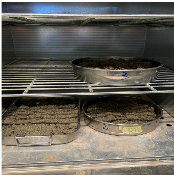
FIGURE 2.16 – 3 échantillons de sable saturé en eau dans une étuve pour séchage
