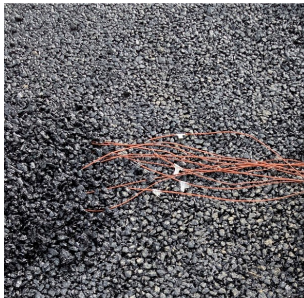
FIGURE 2.20 – Thermocouples type T posés dans la chaussée
