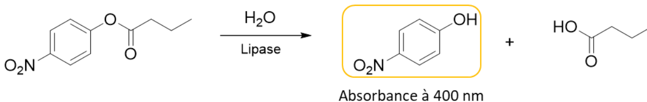
Figure 38 Principe du test d'activité des lipases basé sur l'hydrolyse du para -nitrophenyl butyrate
