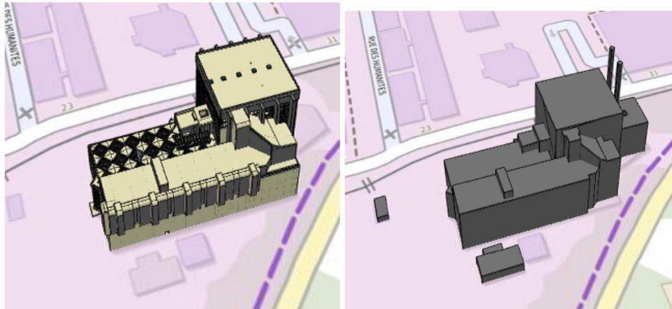
**Figure 4.4 :** Visualisation de deux représentations spatiales d’une même entité (ici un bâtiment) issues de données IFC et CityGML, transformées en 3DTiles
