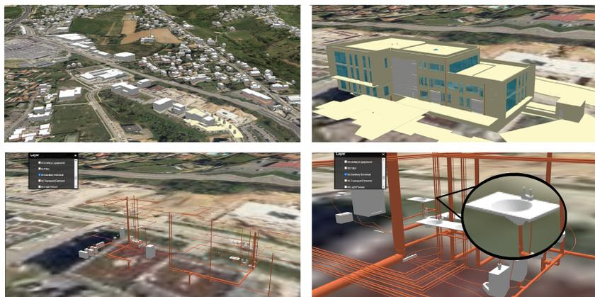
**Figure 3.7 :** Création de vues contextuelles, depuis une vue de la ville d'un bâtiment à l'aide d'une représentation spatiale CityGML (en haut à gauche) jusqu'à une vue d'un objet dans ce bâtiment à l'aide d'une représentation géométrique IFC (en bas à droite), adapté de [Col+22]
