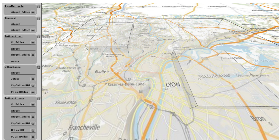
Figure 5.13 : Vue des entités sous UD-Viz. 5 entités géospatiales sont visibles : la métropole de Lyon, deux villes : Villeurbanne et Limonest, et deux bâtiments à l'intérieur de ces villes. Elles sont affichées sous forme de simples cubes géolocalisés dans la scène 3D (à droite) et sous forme de liste avec les variants disponibles pour chacune d'entre elles (à gauche).
