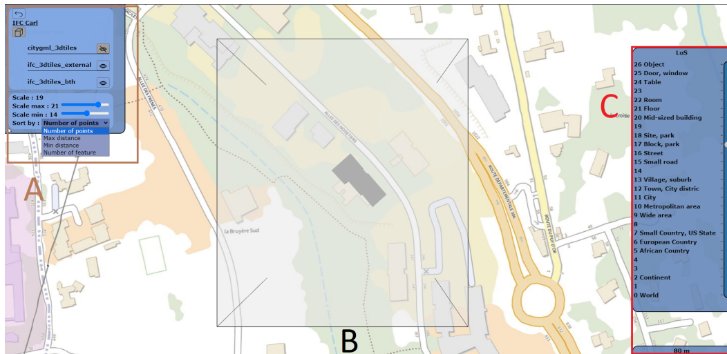
Figure 6.15 : Interface de l'expérimentation mise en place pour comparer différents LoC. Dans le cadre A, on retrouve le LoS de l'entité, le LoS minimum et maximum et le critère utilisé pour calculer le LoC. La bounding box B représente l'espace qu'occupe l'entité. Le cadre C représente les différents niveaux d'échelles et le niveau d'échelle courant.
