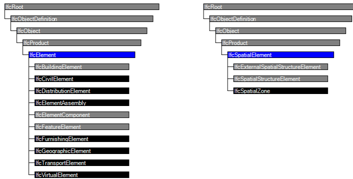
Figure 6.6 : Héritages des types IfcElement et IfcSpatialElement selon le modèle IFC.
