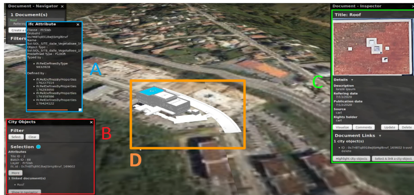
Figure 3.6 : Vue contextuelle d'un toit constituée de représentations thématiques issues d'un fichier IFC (dans le cadre A), de la géométrie (dans le cadre B), d'un document (dans le cadre C), et d'une représentation spatiale issue de la géométrie d'un fichier IFC (dans le cadre D) [Col+22]
