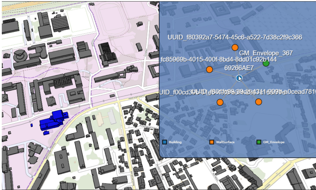
Figure 4.6 : Visualisation d'un bâtiment à l'aide d'une représentation thématique, sous forme de graphe, et d'une représentation spatiale, sous forme de géométrie 3D, issues de données CityGML. Ces représentations sont liées, permettant d'interagir entre elles.
