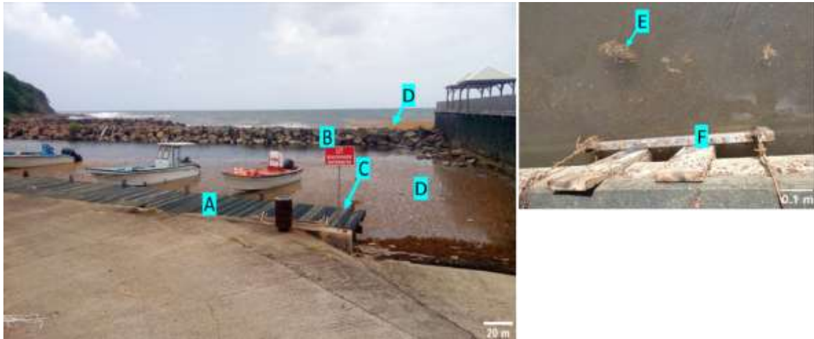
Figure II-3 Photographie du Port du Marigot en présence de sargasses échouées (gauche) et patch de sargasses en décomposition (droite). A : ponton d'amarrage, B : digue, C : zone de fixation des échantillons, D : sargasses échouées, E : patch de sargasses en décomposition et F : dispositif d'exposition des coupons d'aciers fixé au ponton.
