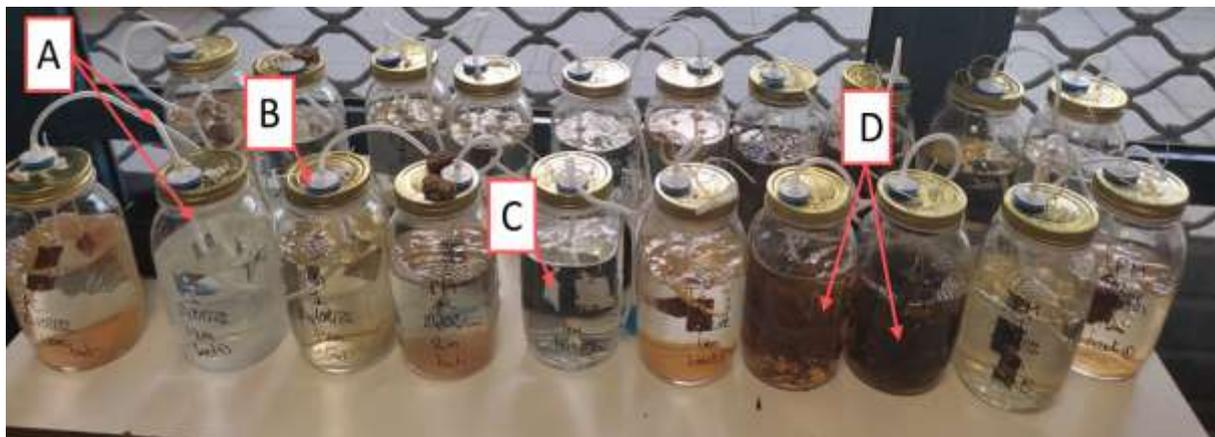
**Figure II-8** Microcosmes réalisés en laboratoire avec les eaux des sites du Port du Marigot et de Cosmy en condition stérile (eau de mer autoclavée), en condition non stérile (eau de mer filtrée) et en condition sargasses (eau de mer filtrée + sargasses). A : tuyau pour aération, B : filtre seringue à 0,2µm, C : coupon d'acier et D : sargasses.
