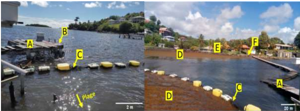
Figure II-4 Photographies de Frégate Est 2 en absence (gauche) et en présence de sargasses (droite). A : ponton, B : zone de fixation des échantillons, C : barrage flottant, D : sargasses, E : zone où est positionné le capteur d'hydrogène sulfuré (H 2 S) et F : plage.
