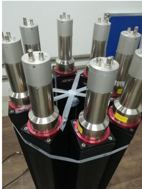
Figure 27. Disposition des détecteurs et de la source de  $^{60}\text{Co}$ , pour la mesure des résolutions temporelles par couples de voies. Les détecteurs sont à un rayon de 15 cm de la source.
