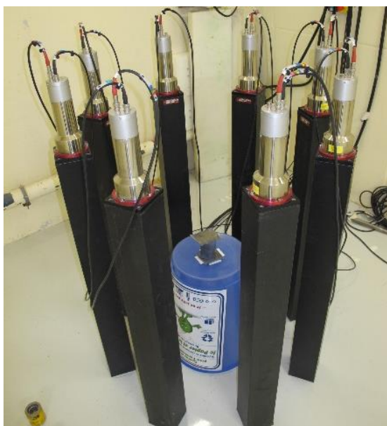
Figure 20. Dispositif expérimental des premiers essais et propriétés des scintillateurs EJ-200 [EJ-200].
