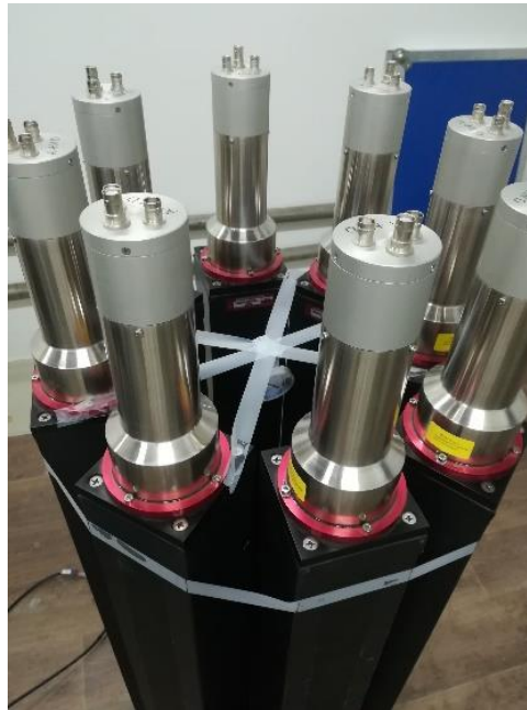
Figure 27. Disposition des détecteurs et de la source de 60 Co, pour la mesure des résolutions temporelles par couples de voies. Les détecteurs sont à un rayon de 15 cm de la source.
