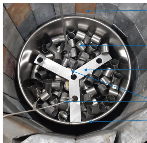
Figure 49. Dispositif de mesure maquette pour fûts de déchets radioactifs de 100 à 220 L.
