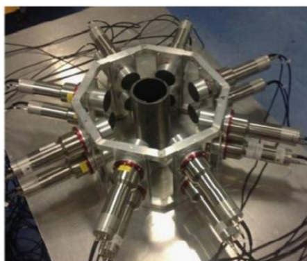
Figure 12. (a) Le dispositif « Fast Neutron Multiplicity Counter » avec 16 scintillateurs liquides EJ-309 orthocylindriques 3" x 3" (Ø 7.62 cm x L 7.62 cm) [Dolan2014] ; (b) Modélisation MCNP pour un dispositif de 32 détecteurs cubiques EJ-309 (7.62 x 7.62 x 7.62 cm³) [Chichester2015].
