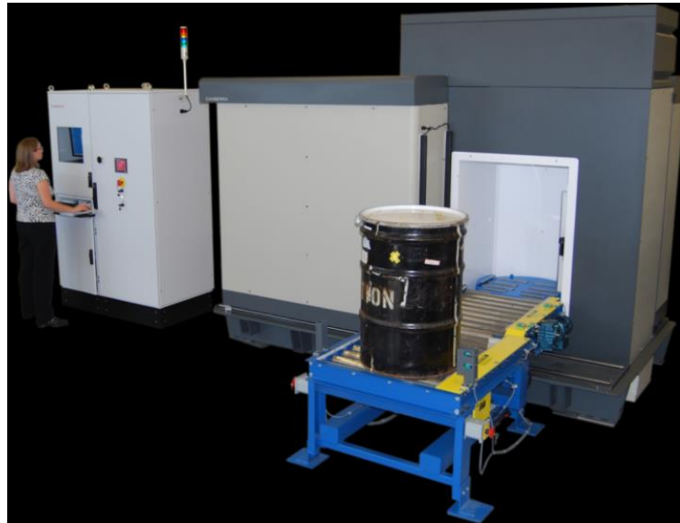
Figure 6. Illustration du WM3100, un HENC commercialisé par Mirion Technologies [Mirion_WM3100].
