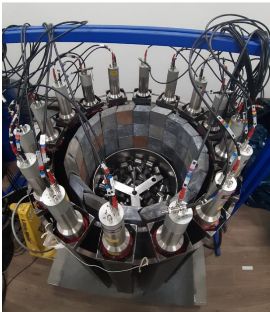
Figure 49. Dispositif de mesure maquette pour fûts de déchets radioactifs de 100 à 220 L.
