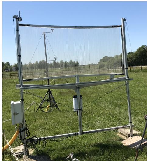
FIGURE 1 – Filet à brouillard du site météorologique du SIRTA conçu par Adèle Moncuquet.
