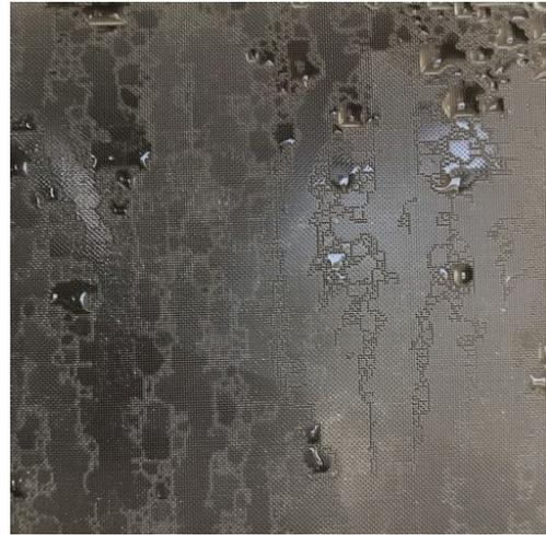
FIGURE 2.35 – Illustration du mouillage de P8 (solidité  $s = 0.7$ , fibres de diamètre  $d_f = 0.13 \text{ mm}$ , pores de même taille), après 5 minutes de collecte avec le dispositif décrit dans la section 2.2.
