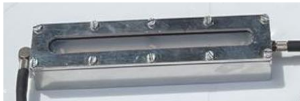
Figure 27. Photoréacteur en acier inoxydable avec fenêtre supérieure en verre Pyrex®
