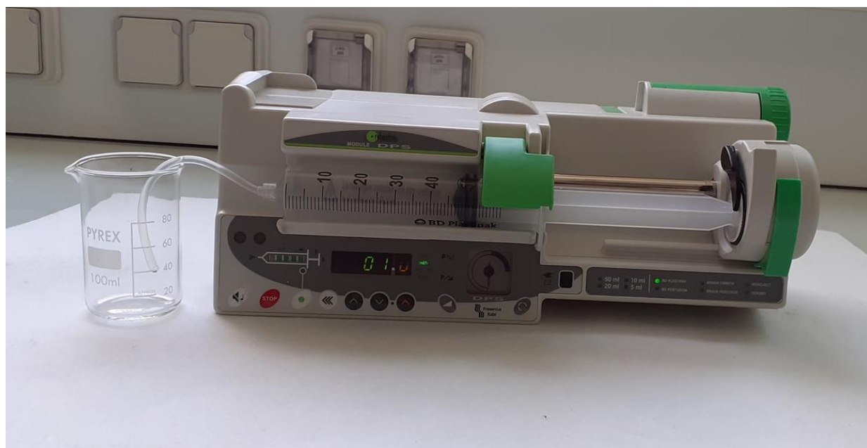
Figure 43 : Montage de perfusion pour réalisation de l'essai de migration en mode dynamique.
