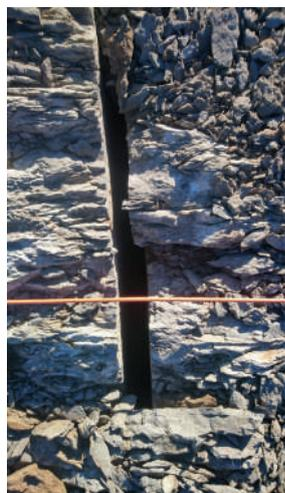
Figure 6.15 : Fracture visible à environ 10 m de la niche d'arrachement, parallèle à cette dernière. La largeur de la fracture est d'environ 5 cm (ph. : 20/09/2022).
