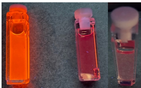
Figure. III. 39. Solutions irradiées sous UV de NPs d'InP synthétisées en présence de \text{In}(\text{OAc})_3 , de \text{Zn}(\text{St})_2 et de différents équivalents de VA : 1- gauche ; 2 - milieu ; 3 - droite.
