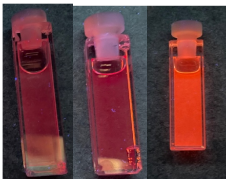
Figure. III. 35. De gauche à droite, brut des synthèses de NPs d'InP avec Zn(OAc) 2 ; Zn(Ste) 2 et Zn(Am) 2 irradiés sous une lumière UV.
