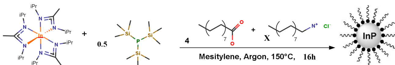
Figure. II. 38. Schéma réactionnel de la synthèse de NPs d’InP en présence de PA et HDA.HCl.
