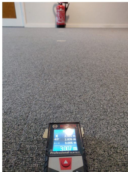
FIGURE C.4 – Disposition du télémètre laser sur le repère au sol face à l'extincteur.
