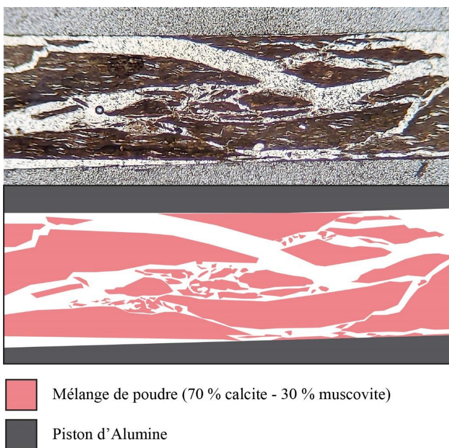
Figure 6-2 : Photo et schéma de l'échantillon CM2. Le mélange de poudre (calcite + muscovite) a été déformé en cisaillement. Les muscovites ont été cisillées et se présentent sous forme sigmoïdale. L'échantillon s'est cependant fracturé durant la décompression et n'est plus cohésif, rendant impossible la reconstitution de l'échantillon à l'extraction de la chemise de platine et la datation in-situ en fonction des structures.
