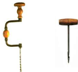
e De gauche à droite : drille à pompe, vilebrequin, vrille (Camps-fabrer 1989, p. 862-865 ; collections particulières)
