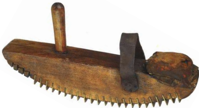
c Marguerite de tanneur ou "paumelle" pour assouplir les peaux, L. 520 mm (Feller et al. 2004, p. 256 ; Maison de l'outil et de la pensée ouvrière, Troyes)
