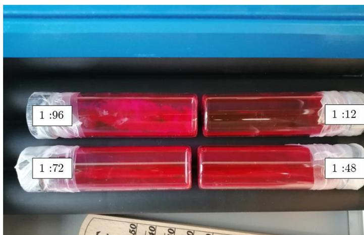
Figure 115 Aspect des échantillons après 1h de polymérisation sur le « roller stirrer » à basse vitesse.
