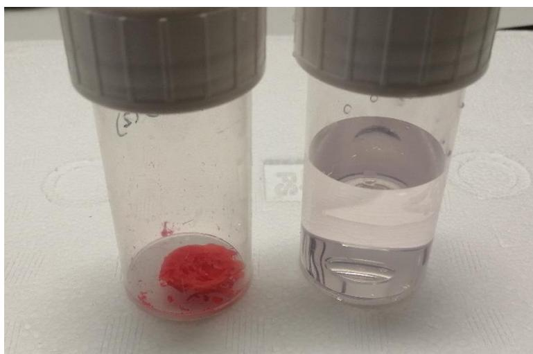
Figure 61 Le flacon de gauche correspond au solide obtenu après séchage du polymère non réticulé. Celui de droite est une solution obtenue après dilution d'un fragment de solide (~1 mg) dans de l'eau distillée. Le fragment se disperse facilement dans l'eau donnant une solution légèrement rosée.
