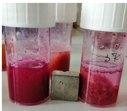
*Figure 94 Aspect des particules en présence d'un aimant. Les particules formées de cette façon sont de taille macroscopique mais les particules magnétiques sont bien intégrées dans la matrice de polymère ce qui les rend très magnétiques.*
