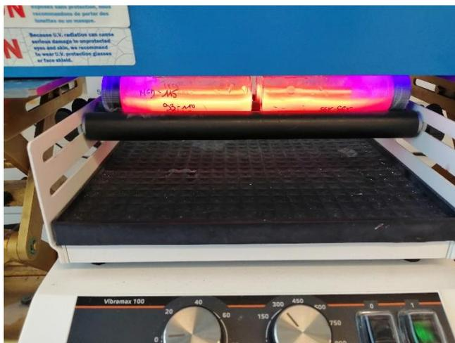
Figure 74 Configuration pour la photopolymérisation de type II.
