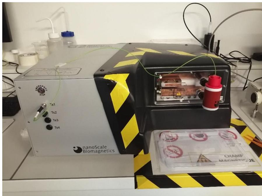
Figure 140 dispositif de génération de champ magnétique alternatif D5 series Automated Driver fabriqué par l'entreprise Nanoscale Biomagnetics.
