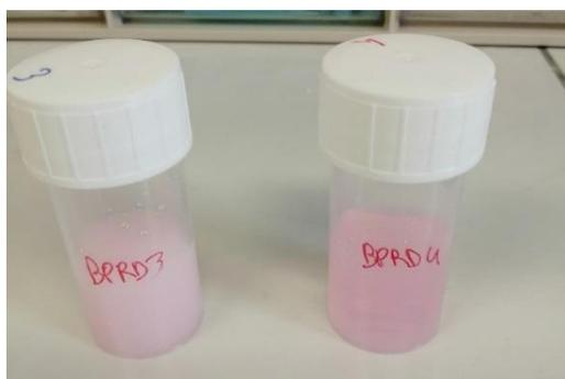
Figure 55 Photographie des échantillons [100 : 0.3] (gauche) et [100 : 0.6] (droite) après dialyse, les échantillons sont troubles mais stables.
