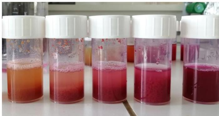
*Figure 93 Aspect des échantillons après amorçage de la polymérisation. De gauche à droite : 0.023  $\mu\text{mol}$ , 0.56  $\mu\text{mol}$ , 1.15  $\mu\text{mol}$ , 2.3  $\mu\text{mol}$  ou 5.75  $\mu\text{mol}$  d'acryloxyethylthiocarbamoyl rhodamine B.*
