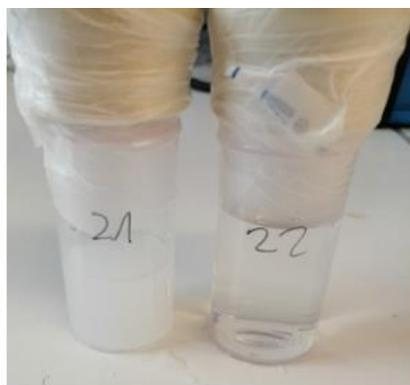
Figure 42 Echantillons après 5h de polymérisation : 21 est l'échantillon concentré et 22 l'échantillon dilué.
