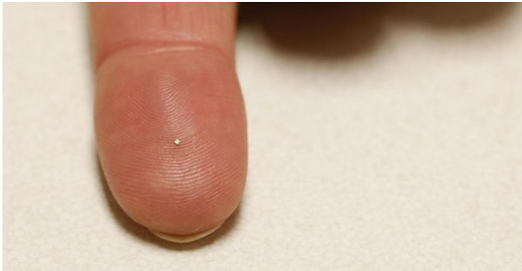
FIGURE 1.2 – La caméra OV6948 d’Omnivision, mesurant 0,575 mm x 0,575 mm x 0,232 mm, est conçue pour des applications médicales et offre une capture de 30 images couleur par seconde à 40 000 pixels de résolution, tout en supportant des températures de -20°C à 70°C
