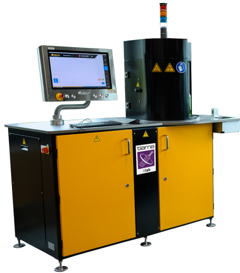
FIGURE 18 – Tomographe Tiama XLab (image fournie par Tiama )
