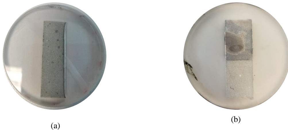
Figure VI.15 Exemples d'échantillons enrésinés pour l'observation MEB : (a) pâte de ciment et (b) composite pâte de ciment/ granulats silice.
