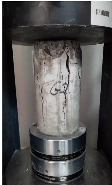
Figure V.6 Dispositif d'essai de compression des cylindres (11x22 cm).
