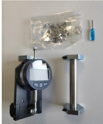
Figure VI.39 Extensomètre à pointeaux utilisé pour mesurer les expansions des éprouvettes cylindriques de béton RSI avec sa barre d'étalonnage.
