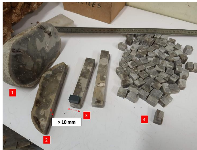
Figure III.4 Quatre étapes progressives de la découpe de la roche de silice.
