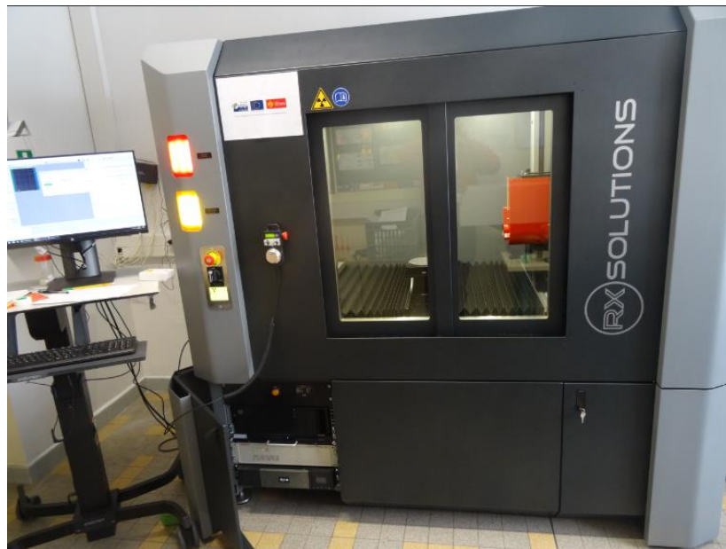
Figure VI.11 Micro-tomographe EasyTom 150 (Plateforme MRI-ISEM, Université de Montpellier).
