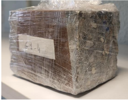
Figure V.9 Partie centrale de poutrelles de dimensions ( 8 \times 8 \times 9 \text{ cm}^3 ) découpée après les essais de flexion 3 points.
