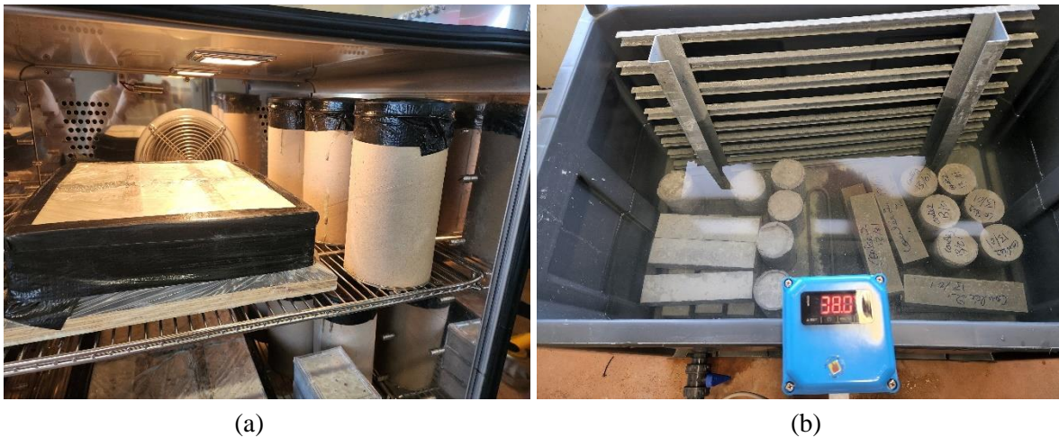
Figure VI.38 (a) Moules cylindriques et parallélépipédiques de béton placés dans l'enceinte climatique avant le début du cycle hygro-thermique et (b) Bac de vieillissement avec thermoplongeur réglé à 38°C.
