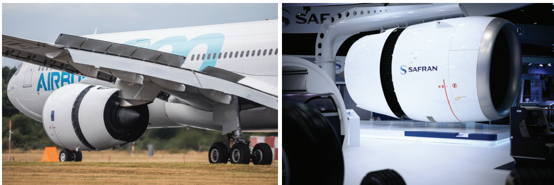
(a) Inverseur de poussée en position dépliement lors de l'atterrissage d'un A330 neo ©Adrien Daste (b) Nacelle d'A330neo avec inverseur de poussée en position ouverte ©Christel Sasso
