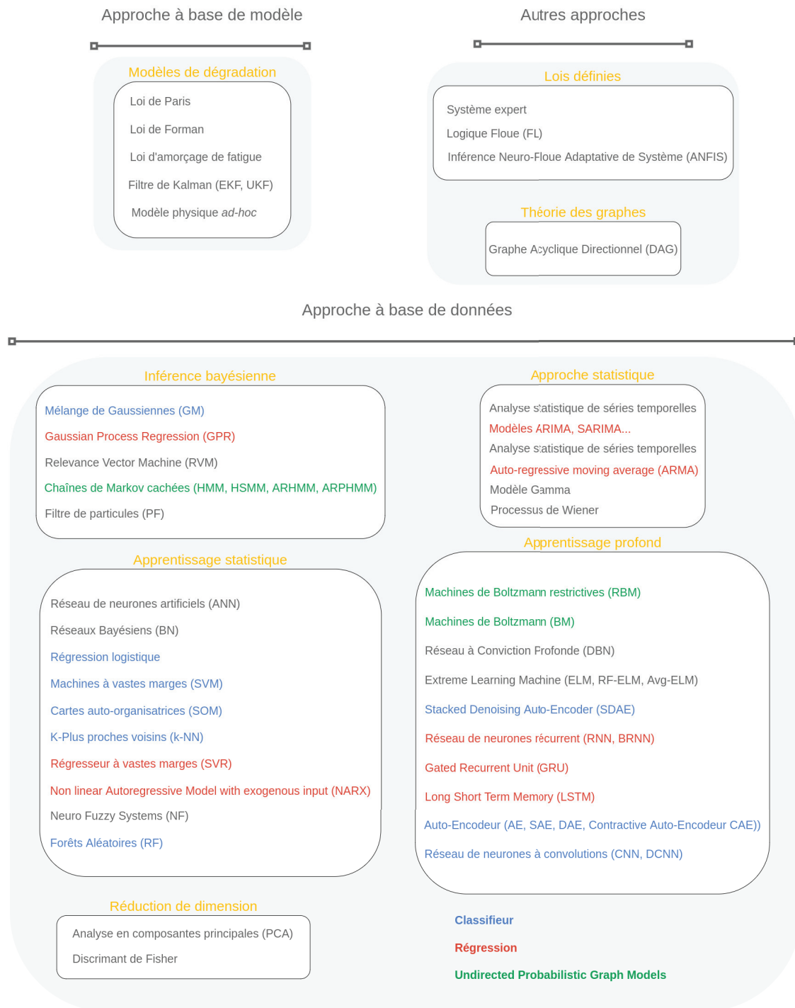
FIGURE 2.4 – Taxonomie des méthodes de PHM utilisées dans l'état de l'art pour du diagnostic et/ou du pronostic
