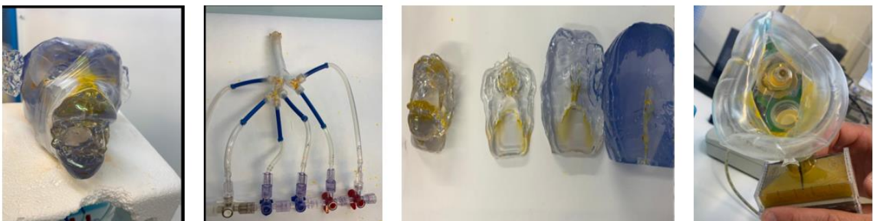
Figure 69 : Essais d'aérosolisation à l'aide du prototype pneumatique et des aérosols de fluorescéine pour visualiser le dépôt dans le modèle in vitro 3D Cast. Les images représentent (de la gauche vers la droite) les dépôts visibles sur la face (museau) ; la trachée, les filtres représentant les divisions bronchiques, les VAS du macaque et le masque après la nébulisation.
