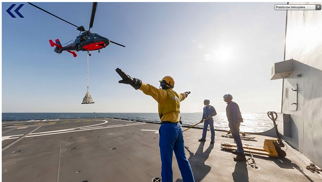
FIGURE 2.7. – Hélicoptère type dauphin livrant du matériel sur la frégate multi-missions Aquitaine. Au premier plan le "chien jaune" guidant le pilote par signe. Depuis https://www.colsbleus.fr/
