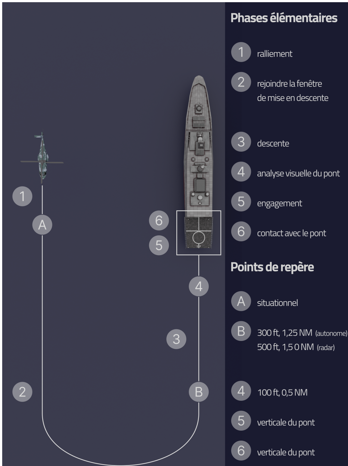
FIGURE 2.11. – Phases élémentaires de l'appontage et points de transitions entre ces phases d'après les entretiens avec les pilotes ALAT et Aéronavale.
