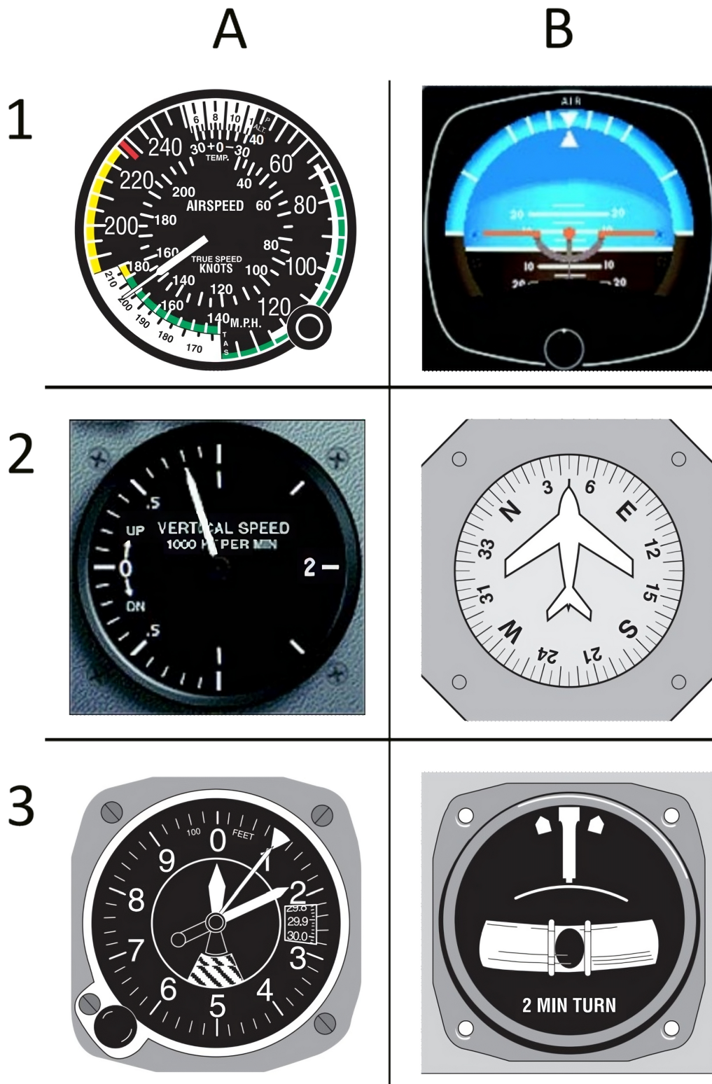
FIGURE 2.4. – Les 6 indicateurs principaux constituant le PFD indiquent la vitesse air (A1), l’attitude (B1), la vitesse verticale (A2), le cap (B2), l’altitude (A3) et le dérapage (B3). Depuis Instrument Flying Handbook (FAA-H-8083-15A) 2011
