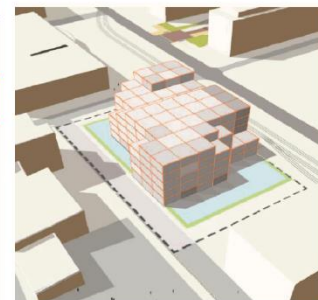
Solution optimisée pour les consommations de chauffage
