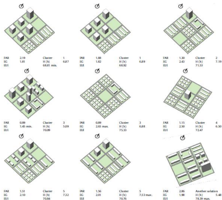
Figure 60: Génération de 9 îlots avec un système de typologies (source : W.Wang et al., 2021)
