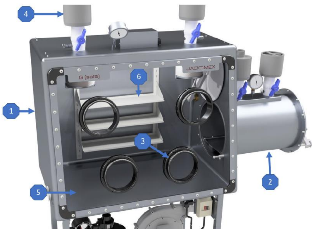
Figure 21. Les différents éléments de la BAG : (1) coque de protection, (2) espace d'entrée / sortie, (3) emplacements des gants, (4) équipement de surveillance de l'environnement, (5) fenêtre et (6) étagères (Tokatli et al., 2021)
