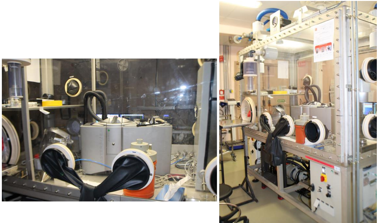
Figure 34 : Granulomètre voie sèche Mastersizer 3000 en BAG.
