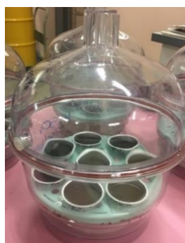
Figure 52 : Enceinte fermée sous humidité relative contrôlée avec coupelles en aluminium.
