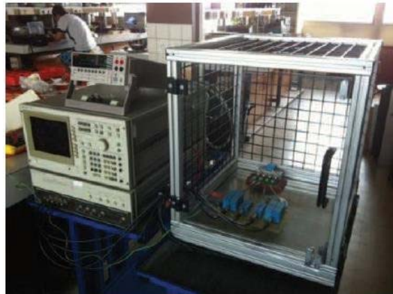
Figure 4.5 : Dispositif expérimental de caractérisation de l'impédance en fonction de la tension [203].
