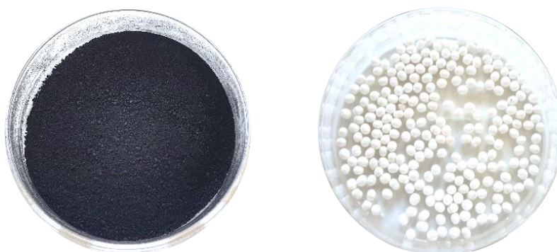
Figure I-7. Charbon actif en poudre (gauche) et billes d'hydrogel de chitosan (droite) utilisés dans nos travaux sur la recherche de stratégies alternatives de récupération des virus dans les matrices hydriques
