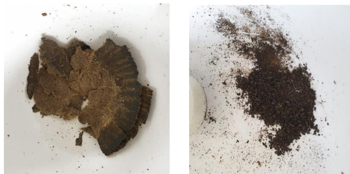
Figure I-1. Boues primaires (gauche) et boues biologiques (droite) obtenues après dessiccation
