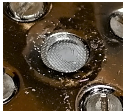
Figure 6.28 – Grille en tungstène tissée installée devant la sortie de la cavité.
