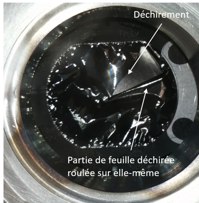
Figure 3.29 – Fenêtre en DLC après mise à l'air de l'ECS. Le déchirement de la fenêtre en DLC est attribué à une mise à l'air brutale de l'ECS après l'étude en ligne.
