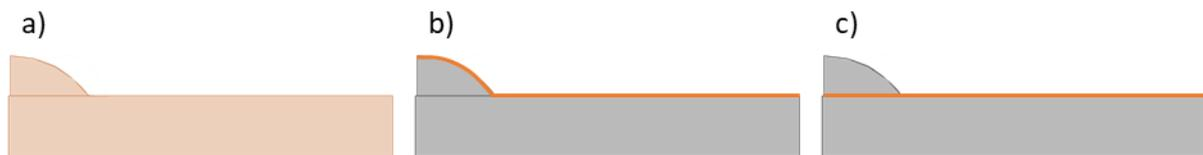
Figure VI-3 : Application de la source a) volumique, b) surfacique à la surface du dépôt ou c) surfacique à la surface du substrat.
