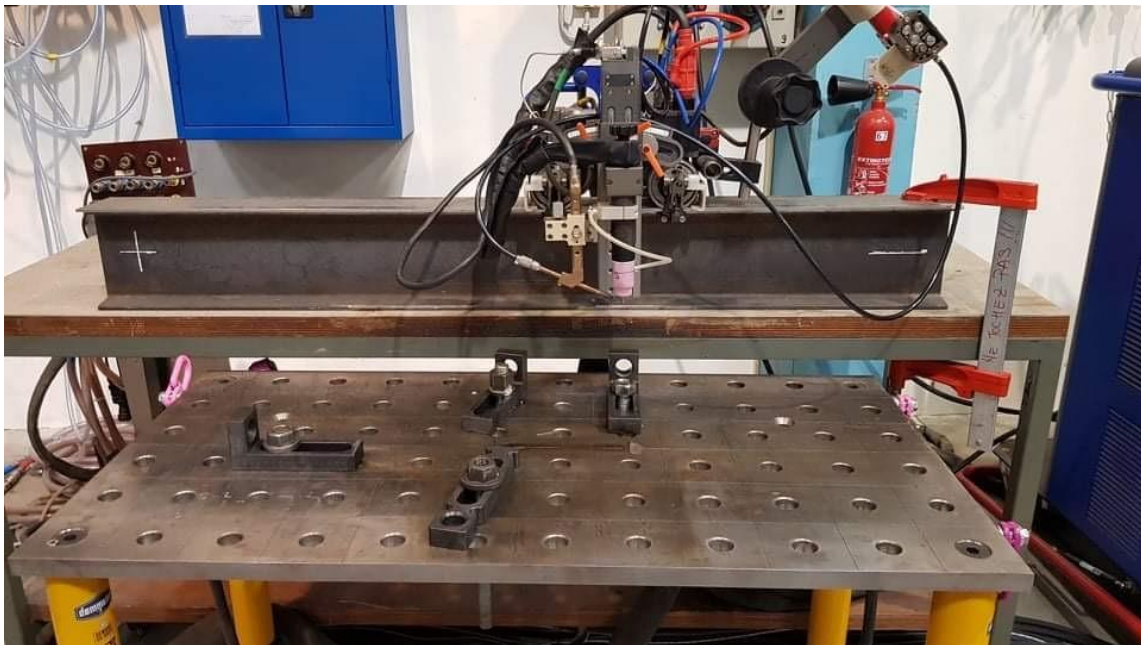
Figure II-11 : Photo du robot linéaire Polycar MP de Polysoude.
