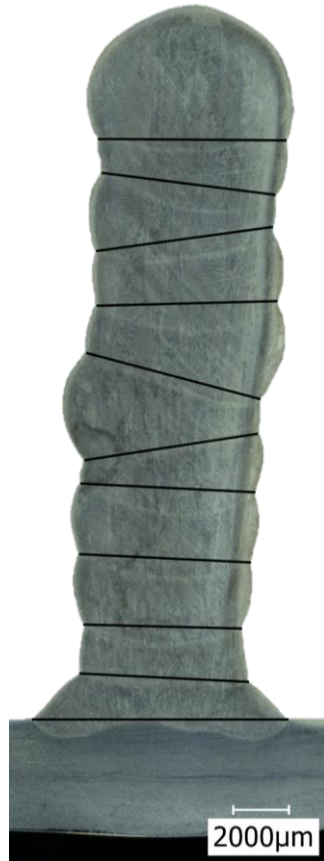
Figure III-25 : Vue transverse du mur construit avec le fil 304L après attaque au réactif de Marble.
