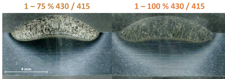
Figure IV-37 : Macrographie des échantillons 1 – 75 % 430 / 415 et 1 – 100 % 430 / 415 après attaque électrolytique à l'acide nitrique fumant.
