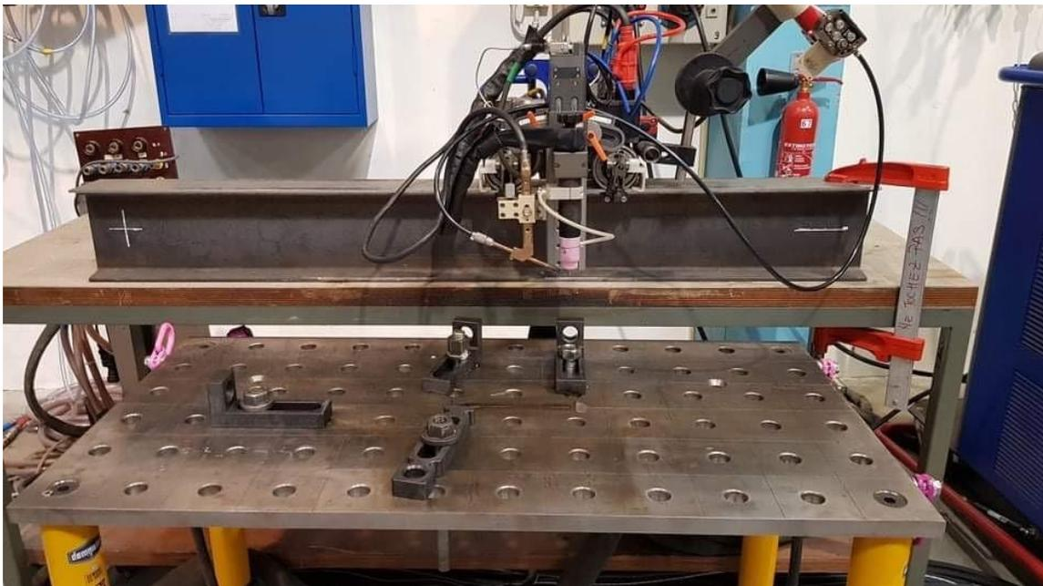
Figure II-11 : Photo du robot linéaire Polycar MP de Polysoude.
