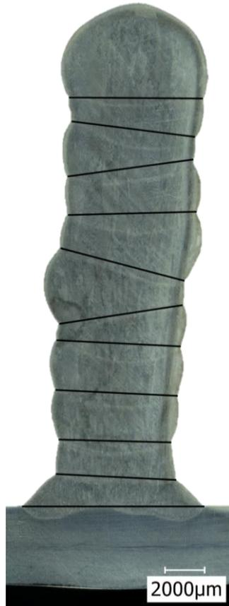
Figure III-25 : Vue transverse du mur construit avec le fil 304L après attaque au réactif de Marble.
