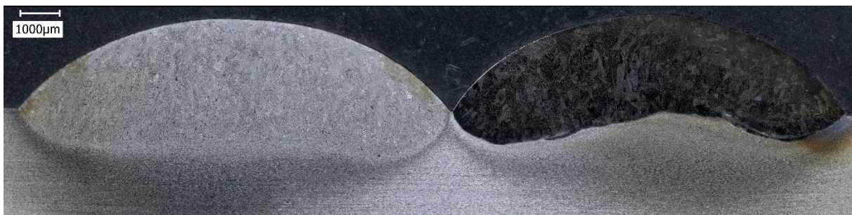
Figure II-16 : Macrographie d'un dépôt de 304L (gauche) et de 415 (droite) sur une tôle de 304L attaqués électrochimiquement à l'acide nitrique fumant.
