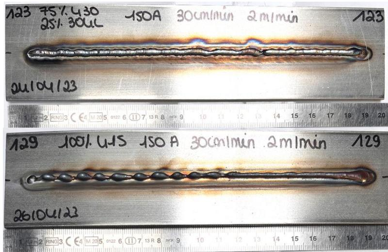
*Figure III-24 : Exemple de cordons présentant des irrégularités en raison du mouvement du (des) fil(s) pendant le dépôt. Ces dépôts n'ont pas été pris en compte dans l'étude en raison des défauts qu'ils présentent.*
