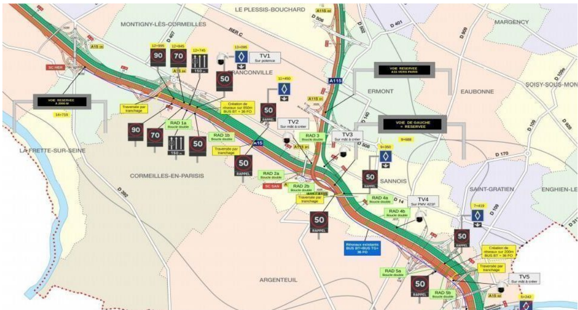
FIGURE B.3 – Synoptique simplifié lié au projet de VR2+ sur l’A15. Source : DiRif
