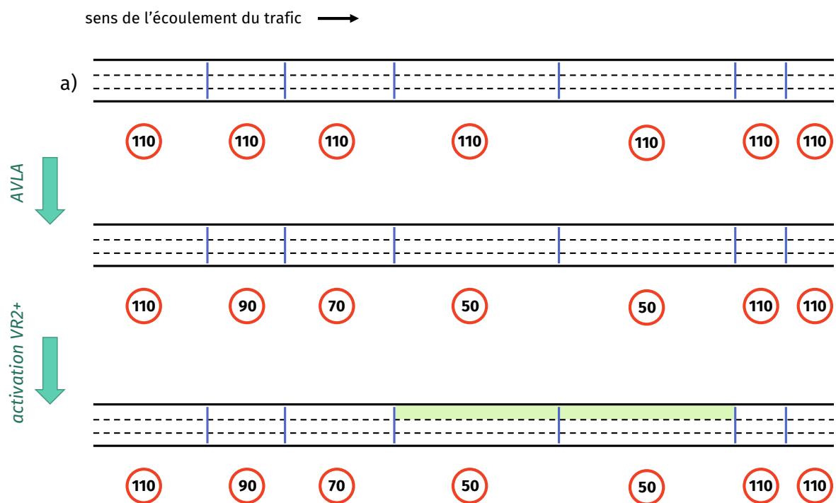
FIGURE 1.5 – Illustration de l'AVLA préalable au déploiement d'une VR2+ à partir d'une autoroute limitée à 110 km/h : a) situation de départ b) résultat de la stratégie. La VR2+ sera déployée sur les 3 e et 4 e sections et limitée à 50 km/h
