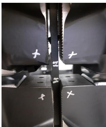
FIGURE 24 – Positionnement de l'éprouvette dans les mors hydrauliques pour les essais de compression (autre côté de l'éprouvette peint en noir pour les mesures infra-rouges et avec des marqueurs à haute émissivité pour la compensation de mouvement).
