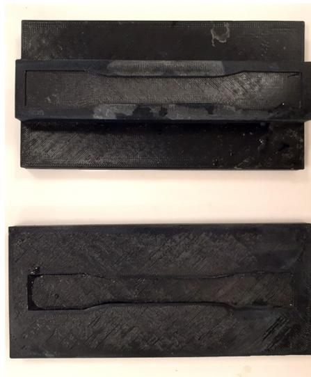
FIGURE 16 – Empreintes en matériau plastique imprimées en 3D utilisées dans le protocole d'amincissement des éprouvettes : empreinte pour le polissage du cœur (en haut), empreinte pour le polissage de la sur-peau (en bas).
