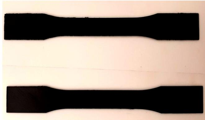
FIGURE 17 – Éprouvettes amincies issues d'une même éprouvette complète.
