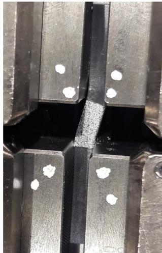
FIGURE 26 – Désalignement des mors d'une machine hydraulique observé pendant un essai quasi-statique en compression.
