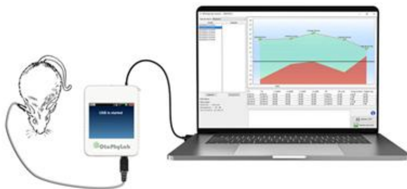
Figure 39 : Exemple du dispositif expérimental d'un enregistrement de produits de distorsion des otoémissions acoustiques (Echodia, France).
