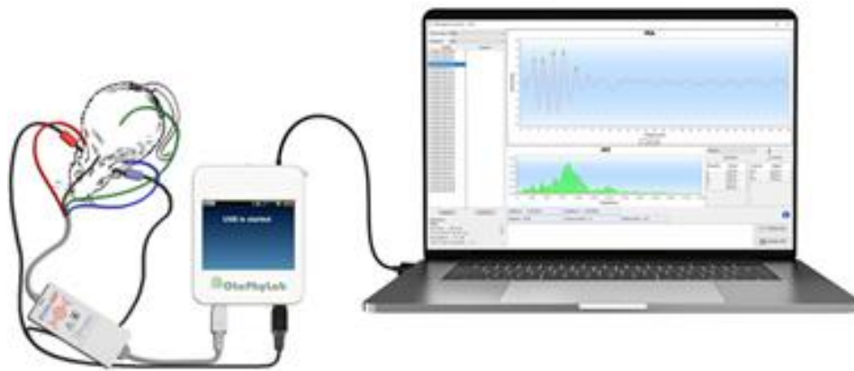
Figure 41 : Exemple du dispositif expérimental d'un enregistrement de potentiels évoqués auditifs précoces (Echodia, France)
