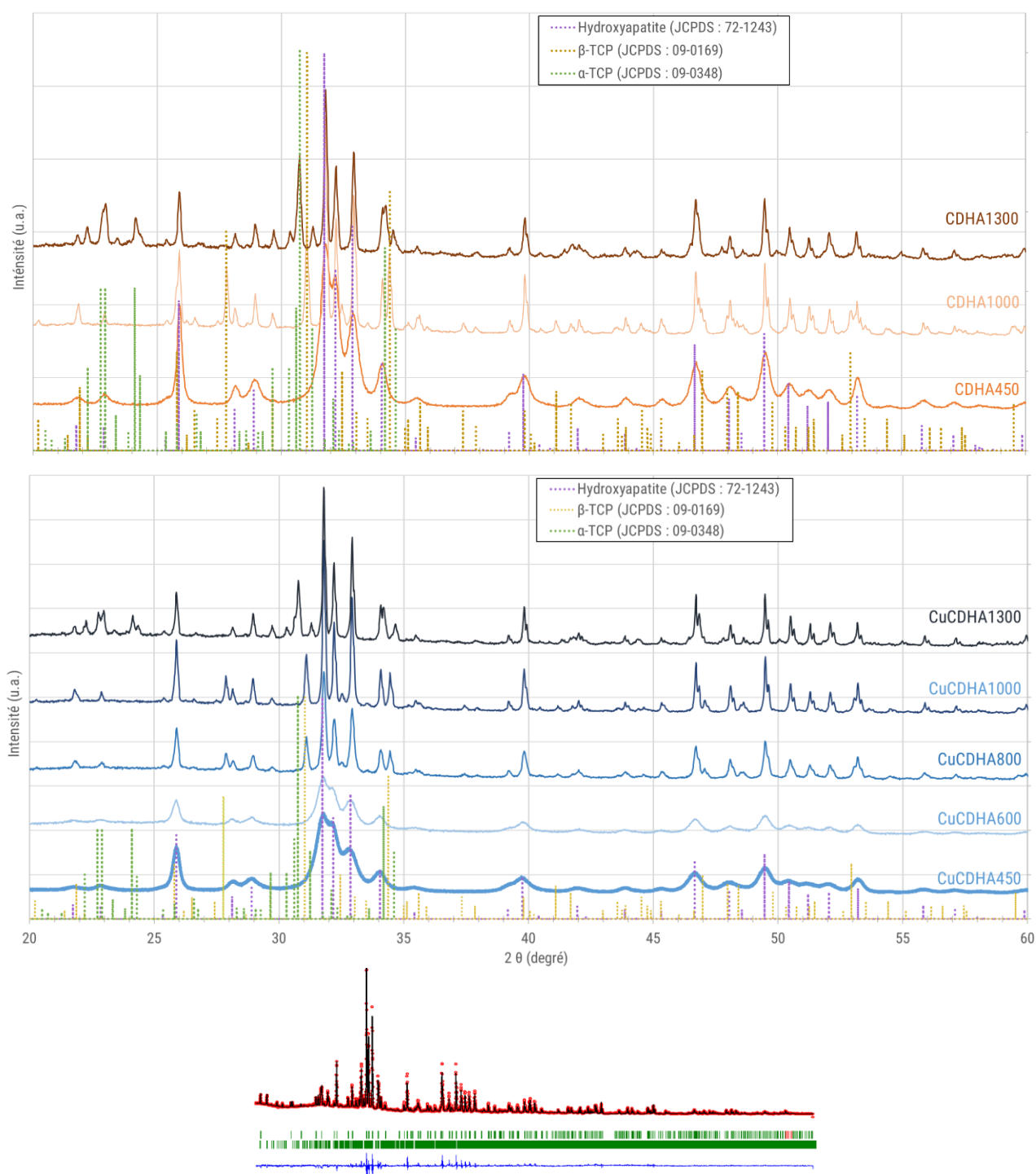
Figure IV.21 : Diffractogrammes des poudres dopées cuivre ou non après des traitements thermiques à différentes températures pendant 10h après une montée de 5°C/min. Un exemple d'affinement de Rietveld représentatif réalisé sur CuCDHA1300 a été ajouté.
