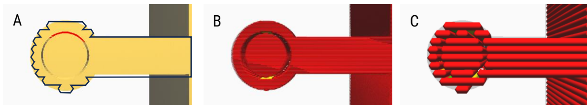
Figure I.20 : Tranchage d'un modèle suivant différents paramètres de couche par le logiciel Cura Ultimaker. A) Modèle initial avec le contour du tranchage à 0,6 mm ; B) Tranchage de 0,1 mm ; C) Tranchage de 0,6 mm. Le tranchage à 0,6 mm a effacé l'espacement à respecter entre le cylindre central et son contour. Un écart est également visible entre le modèle numérique et le tranchage qui est à l'origine d'un effet de marche.
