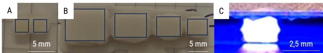
Figure III.23 : Photographies des pièces après (A, B) et lors de l'exposition durant l'impression (C). On peut observer une déformation dans le plan conduisant à une connexion entre les pièces. Les cadres bleus correspondent à la forme attendue.
