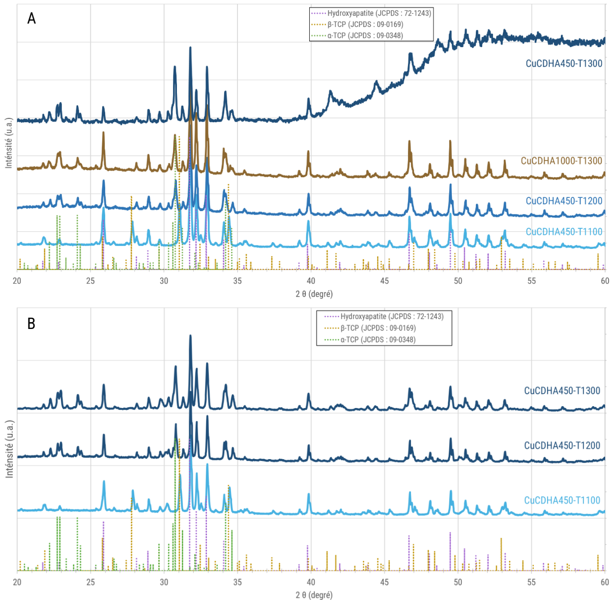
Figure IV.22 : Diffractogrammes des pièces dopées au cuivre après des traitements thermiques à différentes températures : A) Mélange au broyeur (CuCDHA450-B9-M4 et CuCDHA1000-B0-M4) ; B) Mélange à l'agitateur (CuCDHA450-B8-M0). La déviation du fond est liée à la réalisation d'un diffractogramme sur pièce, elle n'a pas été corrigée sur CuCDHA450-T1300A.
