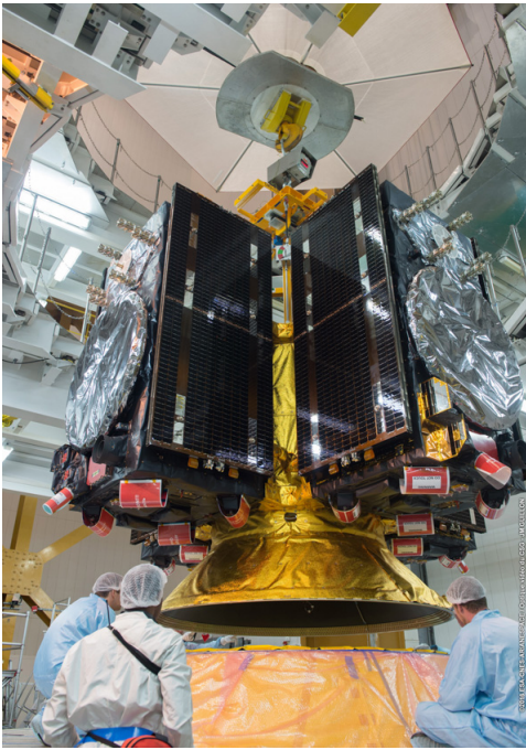
(a) Support de charge utile du lanceur Ariane 5 agrémenté de 4 satellites Galileo [BURRI 2020 ; BURRI et LEGAY 2023]. Crédits photo : European Space Agency .
