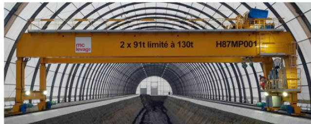
(c) Portique de levage sur site nucléaire. Crédits photo : Mc Levage - RÉEL
