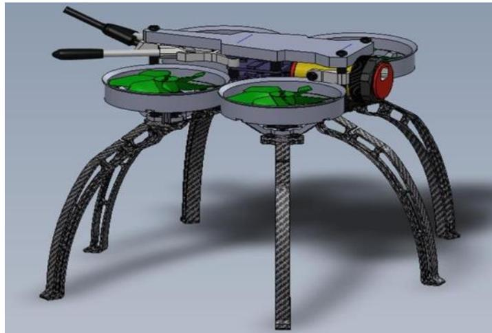
Figure 2.7 : Conception du drone avec capteur fthir
