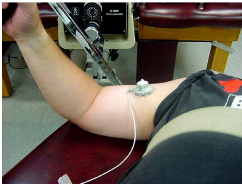
FIGURE 1 – Photographie d'un accéléromètre et d'un capteur de contact piézoélectrique. L'accéléromètre (à gauche) est relié au fil et le capteur de contact piézoélectrique est positionné à sa droite. Image issue de l'étude de Beck et al. (2006)
