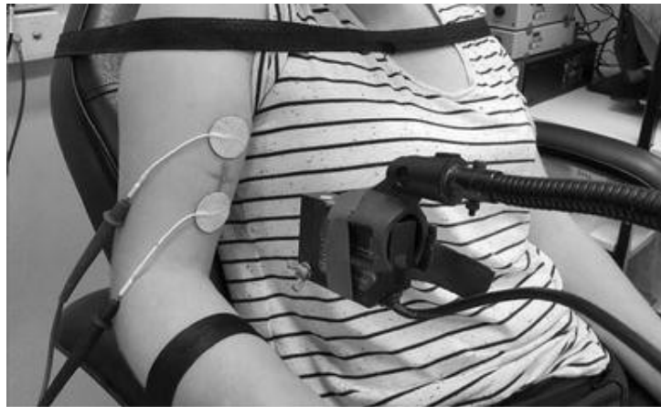
FIGURE 3 – Photographie d'un dispositif laser MMG. Image issue de l'étude de Than et al. (2016)
