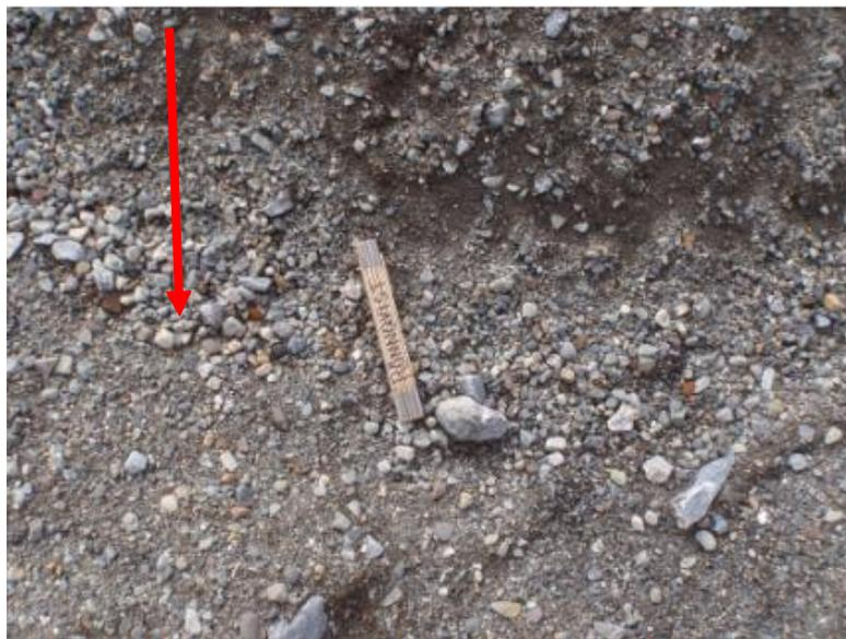
Figure 1.6 : Différents degrés de ségrégation des sols sable-gravier et pierreux observés par Hans Rönnqvist (2017), avec la séparation des grosses particules et des fines
