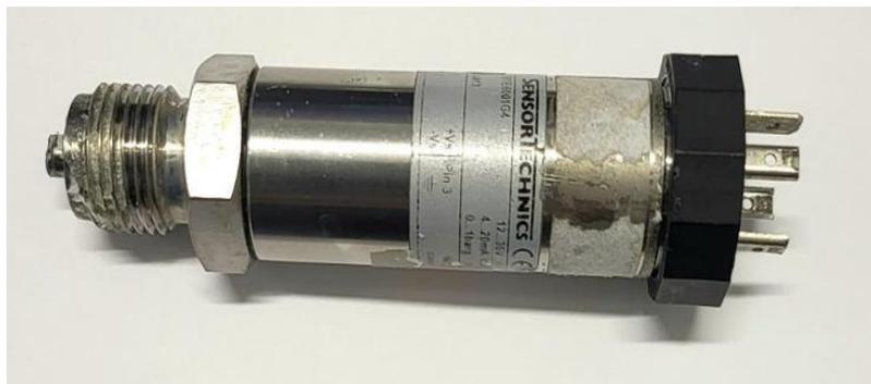
Figure 2.15 : Photo du capteur de pression hydraulique de type Sensor Technics BTE6001G4.
