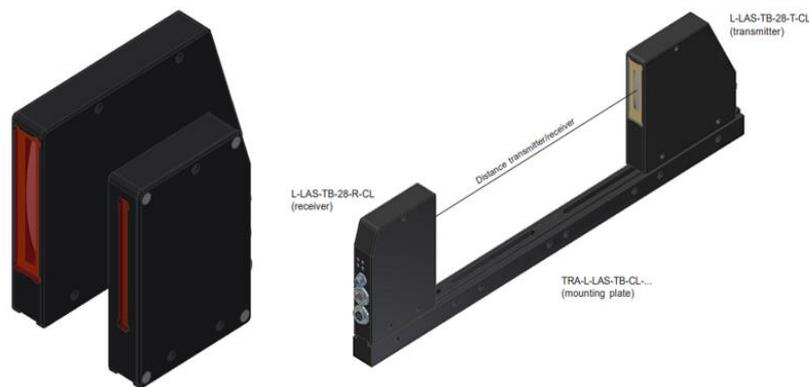
Figure 2.19 : Capteur laser de marque Laser Line Sensors de type L-LAS-TB-28-CL, Transmetteur – récepteur de laser (plage de mesure 28 mm, précision :  $\pm 2 \mu\text{m}$ )
