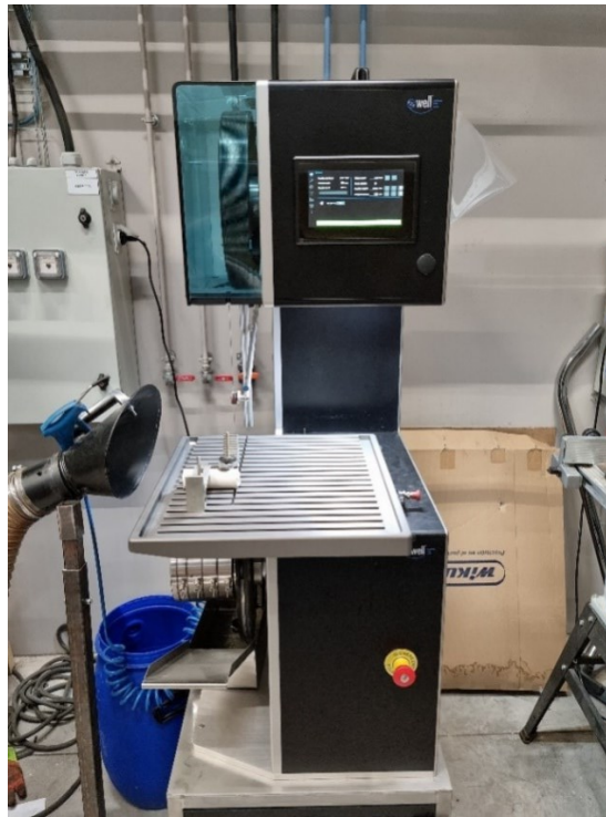
Figure 3.4 Scie à fil diamantée
